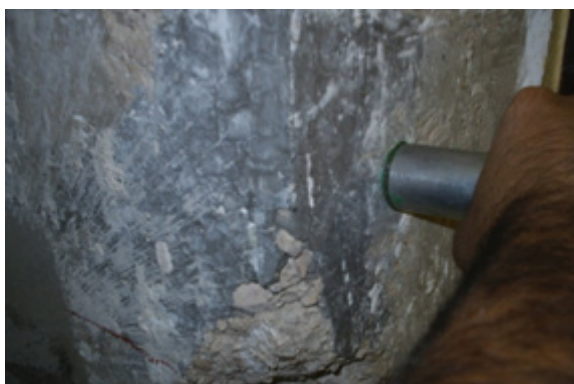
Figura 1. Ultrasonic Tester (superior). Análisis in situ mediante ultrasonidos (inferior)
