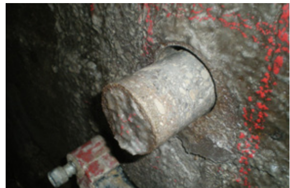
Figura 2. Proceso de extracción de una probeta testigo de hormigón, tras la realización del ensayo mediante ultrasonidos
