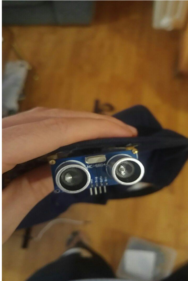
Figura 14. Proposición para la sujeción de los ultrasonidos en la gorra
