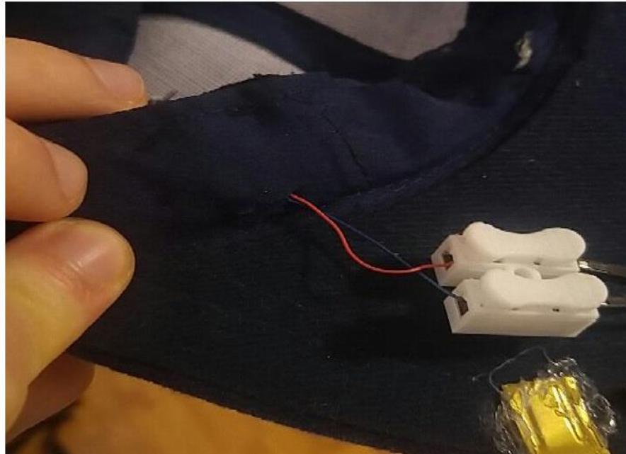
Figura 16. Proposición para la disposición de los vibradores en la gorra
