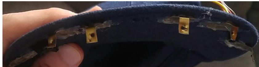
Figura 15. Proposición para la disposición de los ultrasonidos en la gorra
