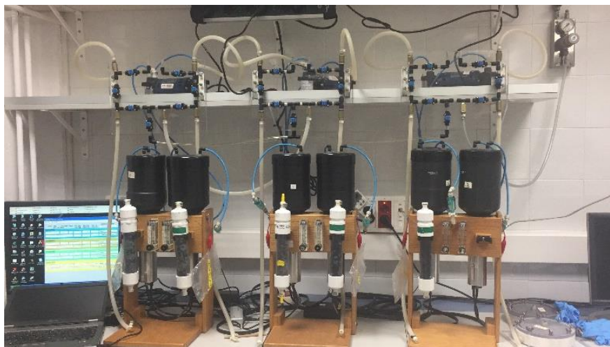
Figura 19: Detector emprat per a mesurar el ^{224}\text{Ra} (RaDeCC)
