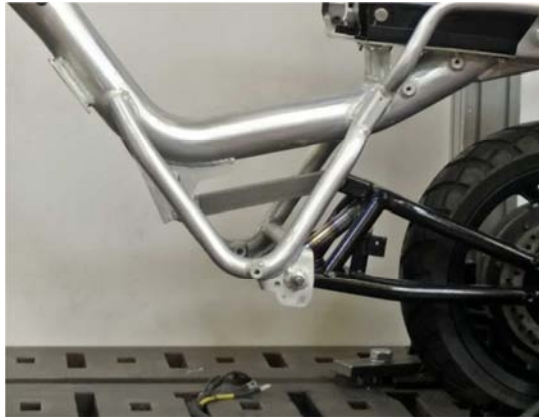
Figura 3.1.6. Particolare della barra in sostituzione dell'ammortizzatore.
