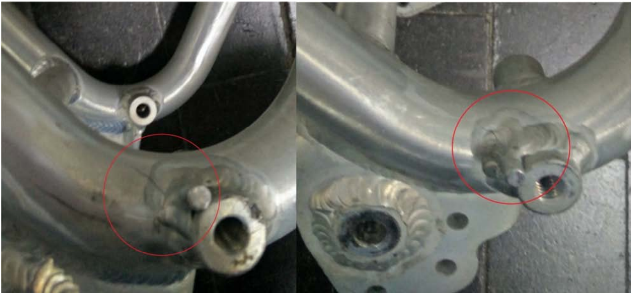
Figura 9.1.2. Rotture ottenute per i primi due telai testati con carico F = 3995 \text{ N} , a sinistra telaio 18_01 a destra il telaio 18_02.
