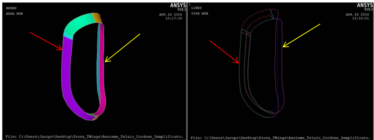
Figura 4.4.3 Volume della saldatura visto tramite a) le aree b) le linee. Le frecce indicano le linee di interesse, la linea rossa indica il perimetro di contatto tra il canotto di sterzo e la saldatura, la linea gialla tra la saldatura e il tubolare del telaio
