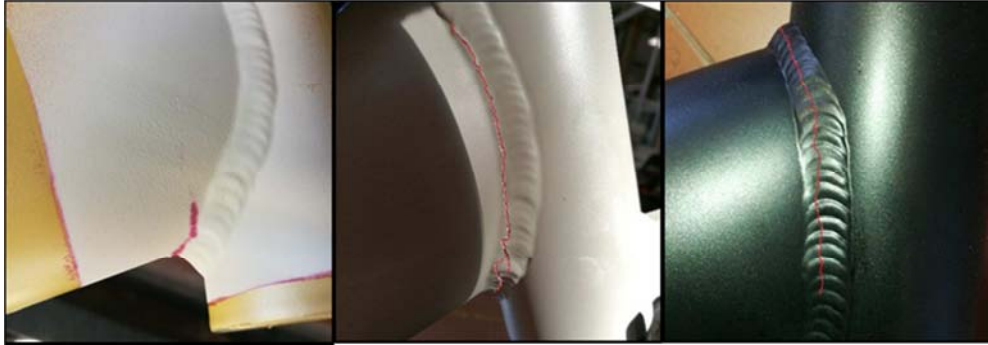
Figura 5.3.1. Esempi di rottura ottenuti da test a fatica effettuati sui telai.
