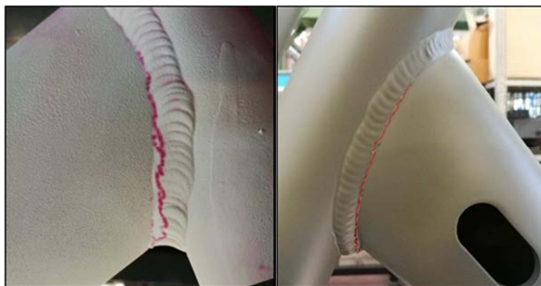
Figura 3.1.4. Esempi di rottura nella zona inferiore.
