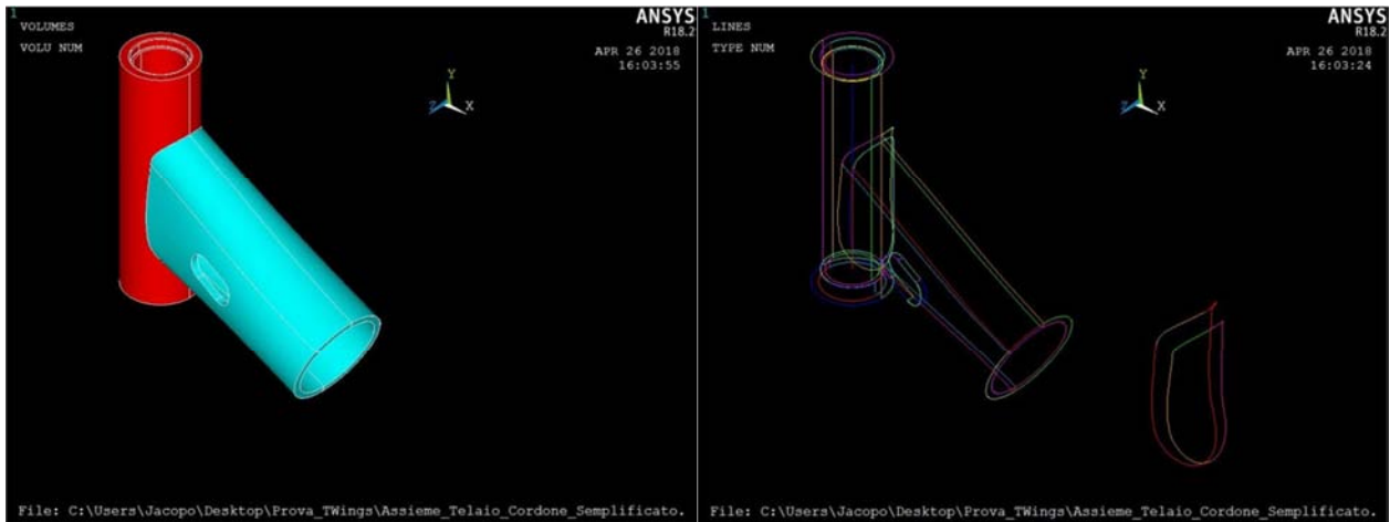
Figura 4.4.7. a) volumi dei due tubolari senza il volume di saldatura, b) linee dei due tubolari e linee di contorno saldatura
