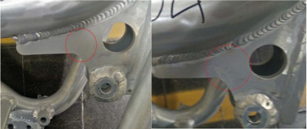
Figura 9.1.3. Rotture ottenute per la seconda coppia di telai, a sinistra il telaio 18_03 e a destra il 18_04.
