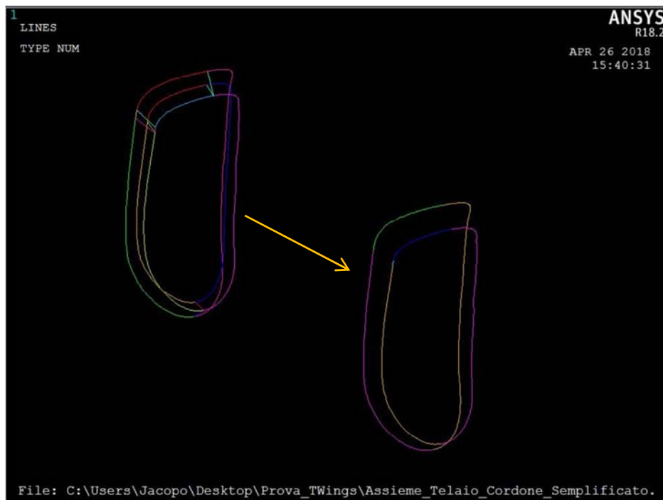
Figura 4.4.4. Passaggio da linee del volume della saldatura alle sole linee essenziali
