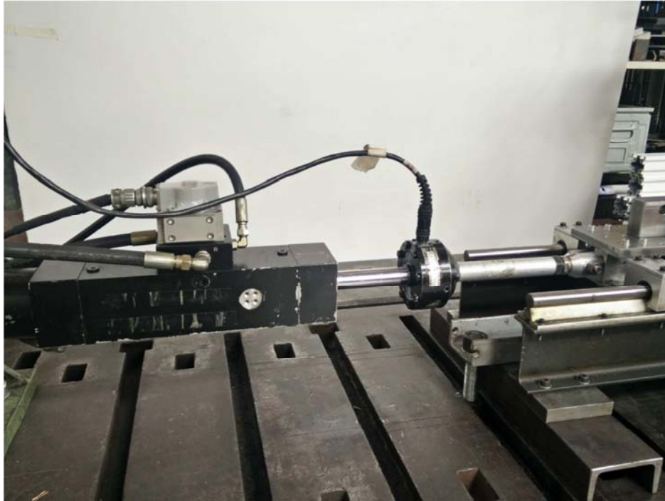
Figura 3.1.8. Martinetto idraulico utilizzato per applicare il carico al telaio.
