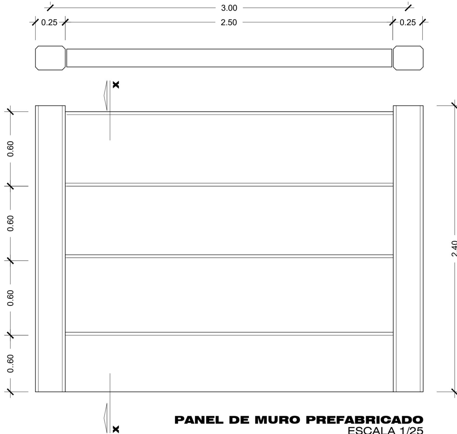
**PANEL DE MURO PREFABRICADO**
