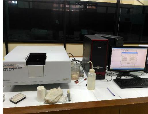
Gambar 8. Pengujian Sampel dengan UV-Vis
