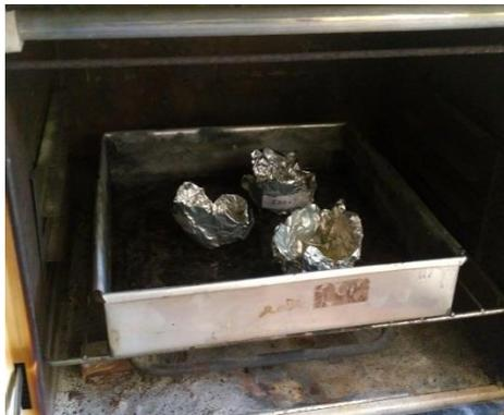
Gambar 9. Pengovenan sampel untuk uji XRD
