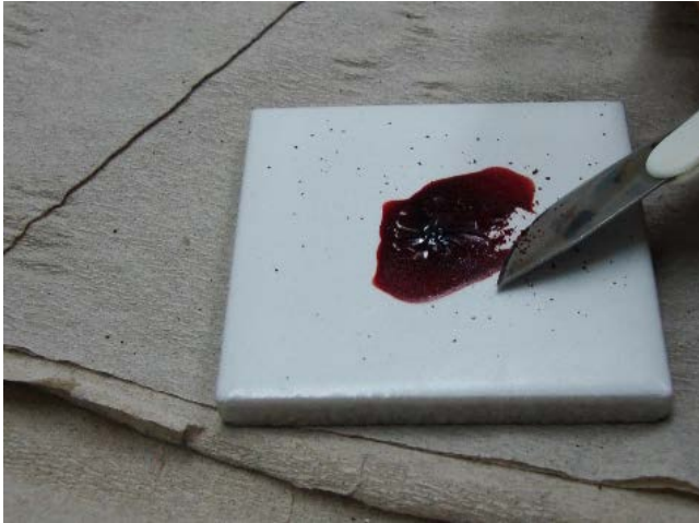
Abbildung 3: Abkratzen des Blutes mithilfe eines Einmalskalpells
