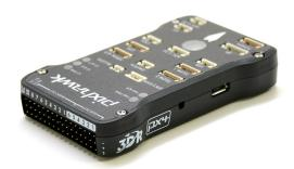
FIGURE 3.2: Pixhawk<sup>®</sup> FMU main module.
