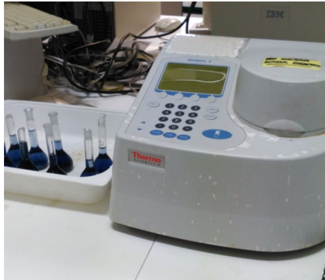
Figura 3. 3. Espectrofotómetro UV/VIS de la serie BIOMATETM 3 de Thermo Scientific. Fuente: Laboratorio de Nutrición y Bromatología de la Escuela de Ingenierías Agrarias.
