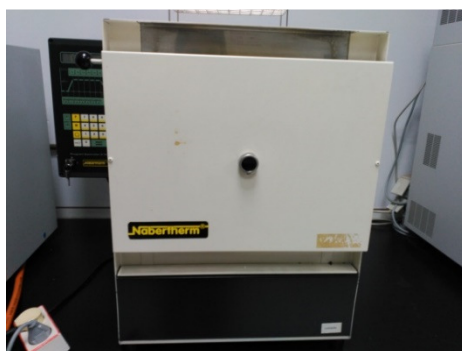
Figura 3. 6. Mufla usada para el horneado de la Aceituna.
