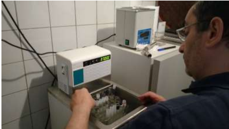
Figura 15. Banho-maria refrigerado usado na refrigeração de sémen.
