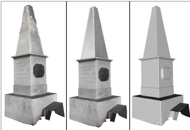
Figura 10. Izquierda: Malla 3D texturizada obtenida con CMP-MVS. Centro: Malla 3D texturizada. Derecha: Malla 3D sin textura.
