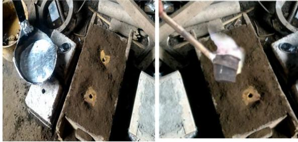
**Gambar 6.** Penuangan ke dalam Cetakan
