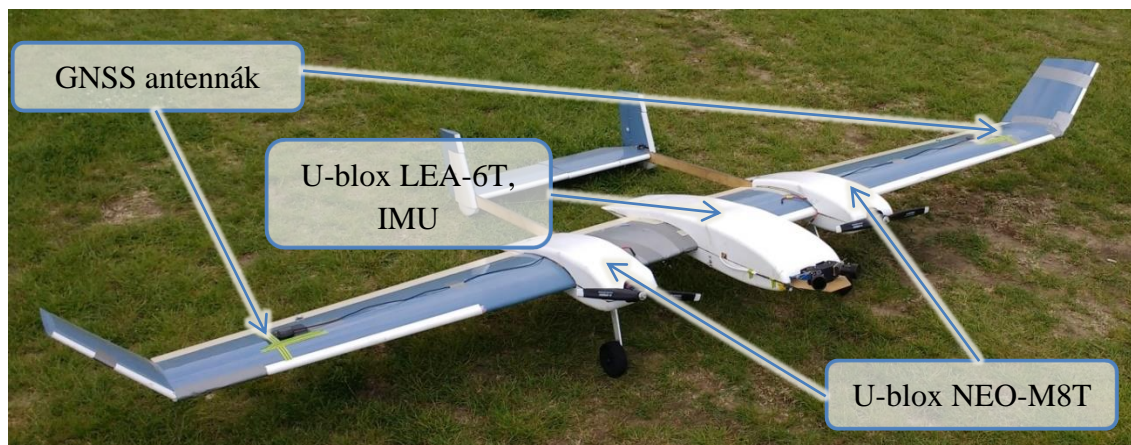
3. ábra A mérést végző UAV és a felhelyezett szenzorok
