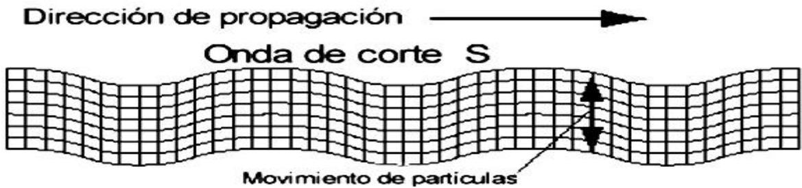
Figura N°8. Onda S. Extraída de <http://luz.izt.uam.mx>
