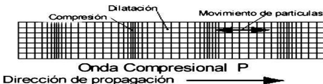
Figura N°7. Propagación Onda P. Extraída de <http://luz.izt.uam.mx/>
