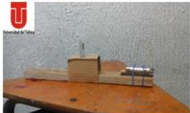
Podemos observar un microscopio hecho con materiales reutilizados y reciclables, como cartón y madera, que se utilizó como apoyo en el laboratorio en clase.
