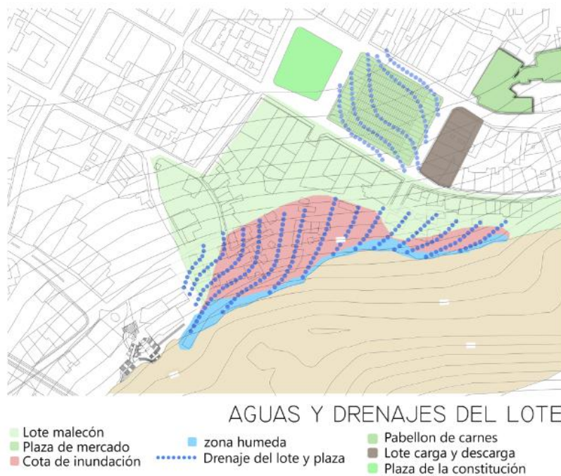
Figura 21. Agua y drenajes
