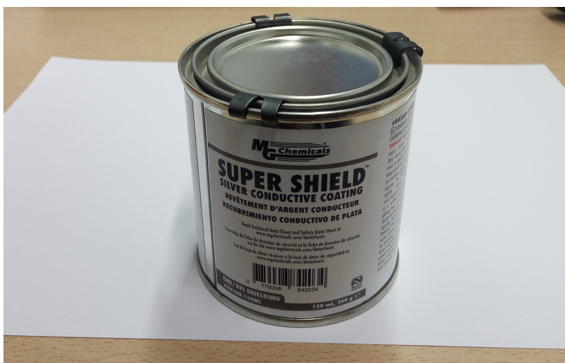
Figura 5.2: Pintura conductora para apantallar las paredes internas del cajeadado en ABSplus .
