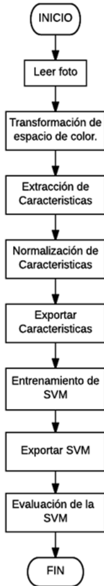
Figura 15. Diagrama de flujo para extracción de características y entrenamiento de la SVM en Java.
