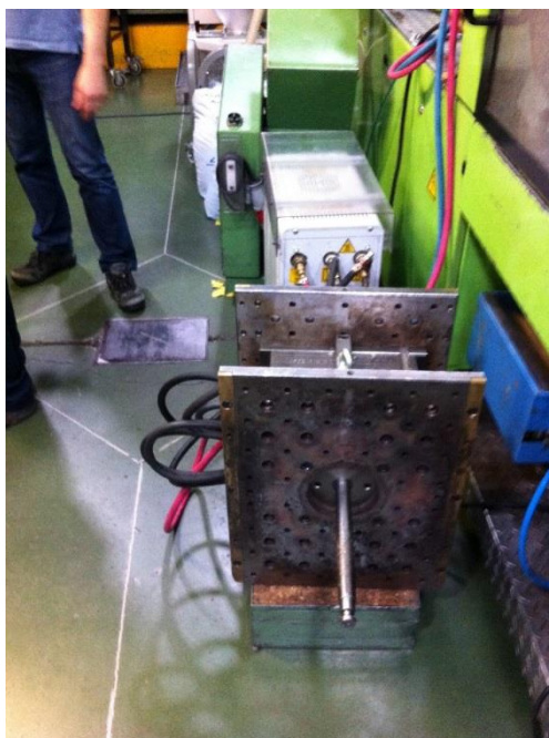
Figura 3.9- Moldes em pré-aquecimento.
