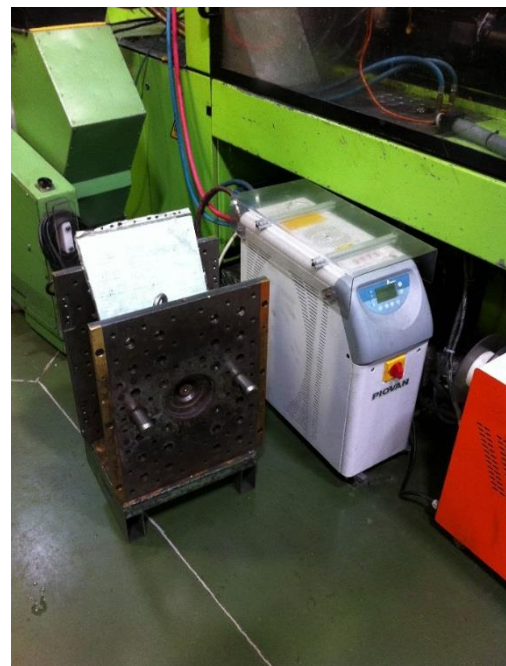
Figura 3.9- Moldes em pré-aquecimento.
