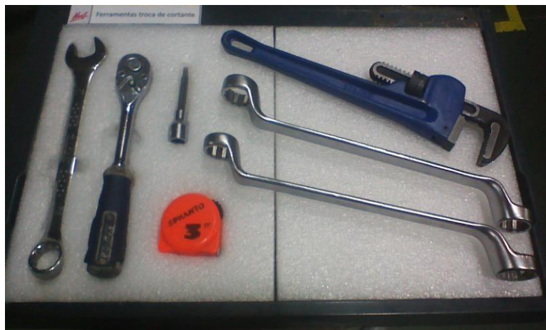
Figura 3.15 - Ferramentas de troca de cortante dispostas em quadro de esponja.
