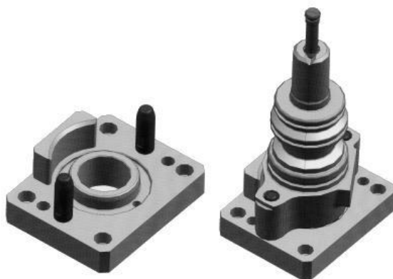
Figura 2.9 - Sistema Poka- Yoke , "anti- erro". A peça só encaixa de uma única forma na base.
