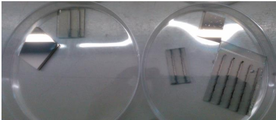
Figura 24 - Amostras submetidas a tratamento térmico sob a forma de linhas e revestimento total da área do substrato.
