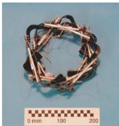
Figura 22 - Estrutura *Tensegrity* fechada, vista superior (Tibert 2002).
