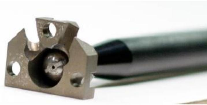
Figura 29 - Esfera do Longeron e junta de ligação (Stohlman 2011).
