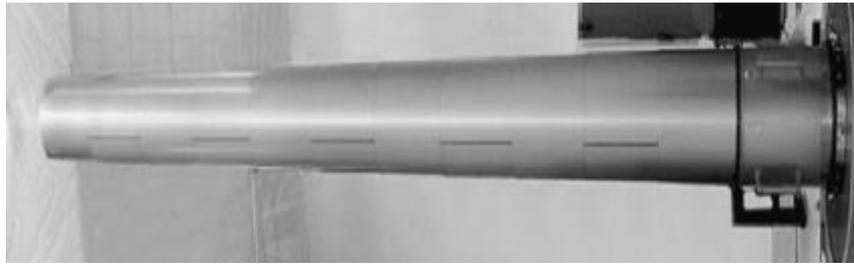
Figura 14 - Estrutura telescópica (Inflatable Sunshield in Space - ISIS) (L. Puig et al, 2010).
