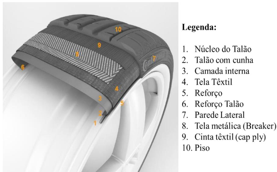
**Figura 2** - Componentes de um pneu [11]
