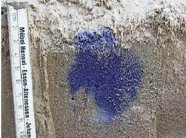
Abb. 4.3 Fotografie eines Längsprofils durch einen zur Illustration mit 100 ml blauer Tinte nach der im Versuch verwendeten Applikationsmethode versetzten Bodenbereich. Das Profil entstand durch Spatenstich im Sandbeet 48 h nach der Markierung.
