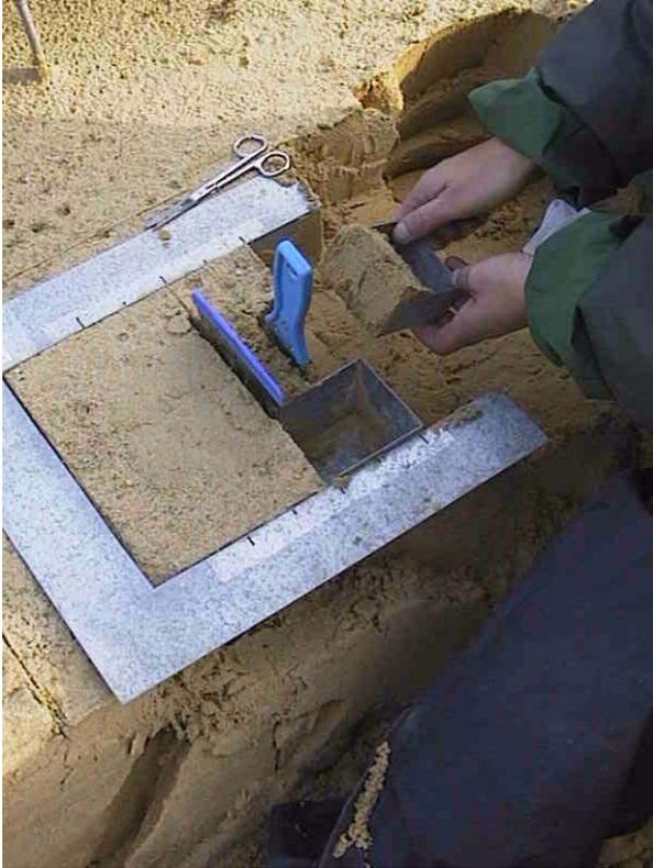
Abb. 3.3 Methode der differenziellen Ernte des Wurzelraums einer Versuchsparzelle im Sandbeet. Oberirdische Pflanzenteile sind bereits geerntet, der Stahlrahmen eingesetzt und die ersten Quader der oberen Schicht entnommen. Zu erkennen sind die Stahlformen für größere sowie kleinere Quader sowie die Spatel.
