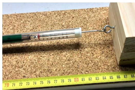
aplicada al bloque, y como se indicó anteriormente, dividiendo ésta entre el área de la superficie inferior  $S$  del bloque, podemos conocer el esfuerzo aplicado. También, conocida la fuerza aplicada justo antes de que el bloque deslice ( $F_i$ ) y la que se observa justo al terminar el deslizamiento ( $F_f$ ), podemos calcular la llamada caída de esfuerzos ( $\Delta\sigma$ ), *stress drop* o diferencia de esfuerzos durante el terremoto, mediante la expresión
