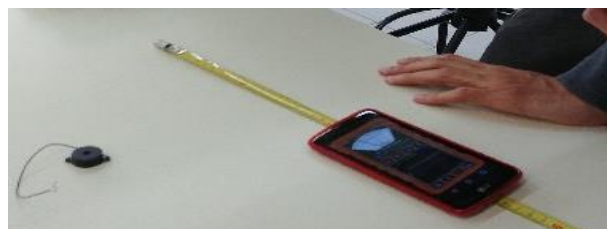
Figura 4. Muntatge experimental per mesurar la intensitat de camp magnètic (amb una app) per cada una de les distàncies entre l'imant i la bobina mesurades gràcies a l'anàlisi de vídeo.
