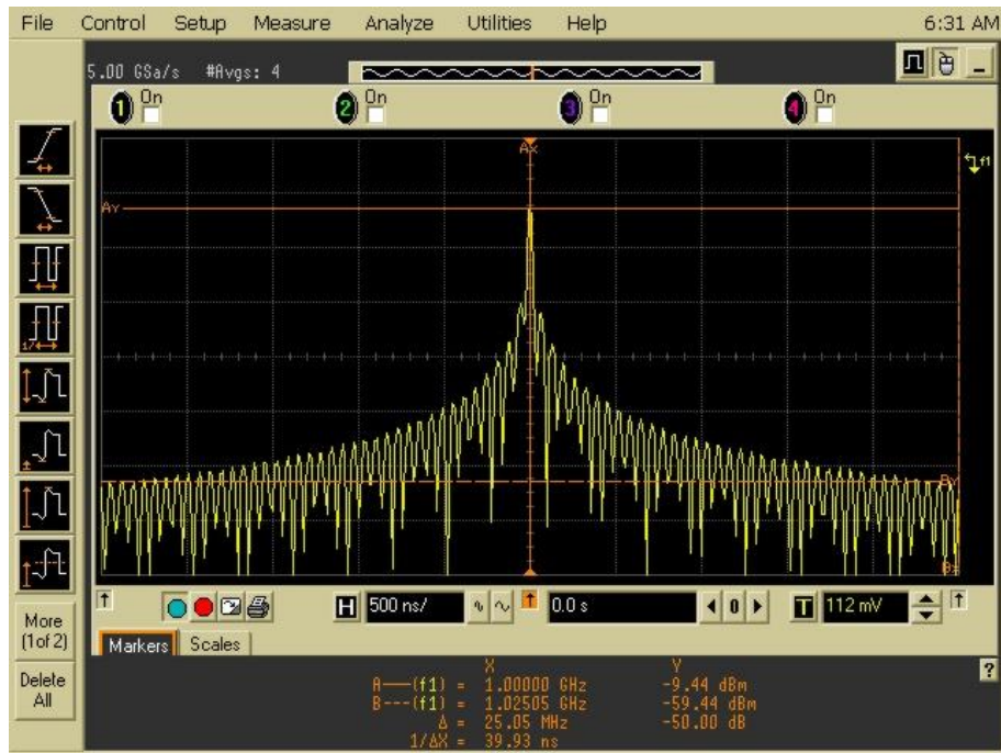
Fig. 3.10 Transmisión del tono utilizando como frecuencia central 1.0 GHz.
