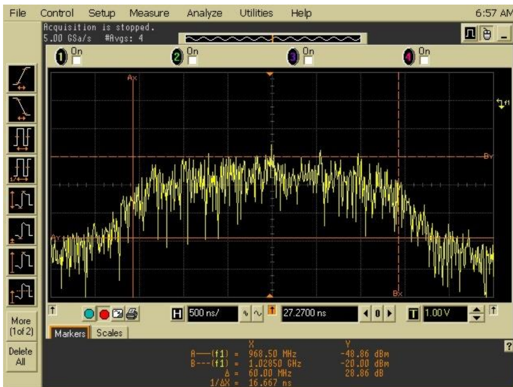
Fig. 3.17 Transmisión de canal de ruido con una frecuencia de muestreo y ancho de banda de 60MHz.
