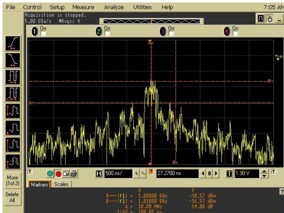
Fig. 3.19 Transmisión de un canal de ruido con un ancho de banda de 5MHz con un factor de sobremuestreo de 2 sin LPF.
