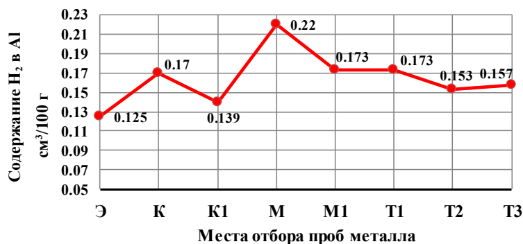
Рис. 7. Изменение концентрации водорода в жидком металле литейного сплава AlSi7Mg: Э – электролизеры; К – ковши до отстоя металла; K1 – ковши после отстоя металла; М – миксеры после заливки металла; M1 – миксеры перед разливкой металла; T1 – T3 – точки отбора проб из литейных желобов в соответствии с рис. 2
