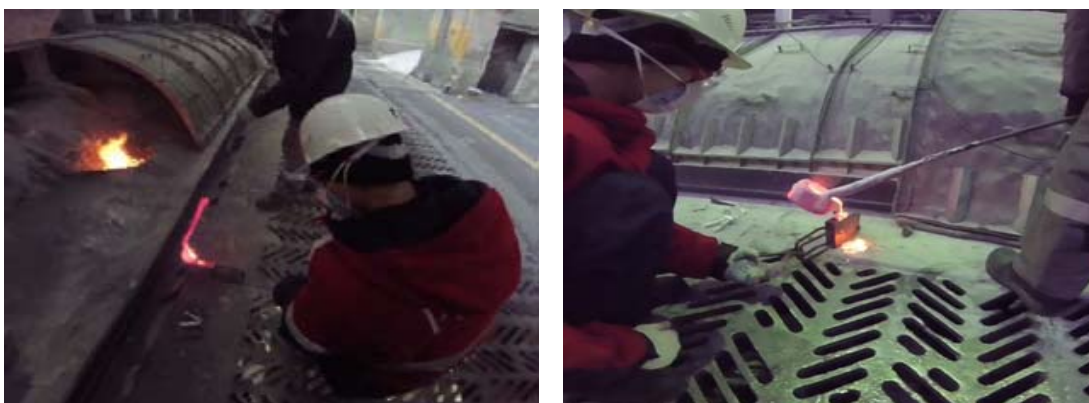
Рис. 4. Отбор проб алюминия из электролизеров
