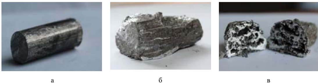
Рис. 6. Внешний вид образцов пресс-изделий после различных этапов обработки: а – после горячей экструзии; б – после осуществления процесса вспенивания; в – поперечный разрез образца пресс-изделия после вспенивания
