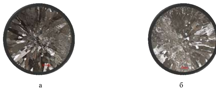
Рис. 5. Макроструктура Alcan-теста проб сплава АД31 без модифицирования (а) и с модифицированием расплава лигатурным прутком диаметром 8 мм из смеси алюминиевой стружки и 2 % порошковой смеси (б)
