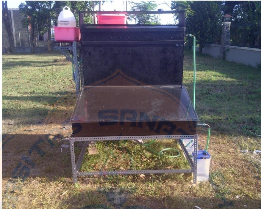
Gambar L. 5 Alat Destilasi Air Energi Surya Berkondensor Pasif menggunakan bak dua tingkat
