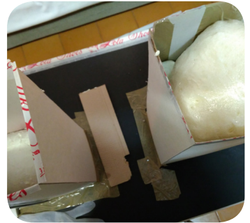
Rellenar de espuma de poliuretano. Dejar secar y retirar molde.
