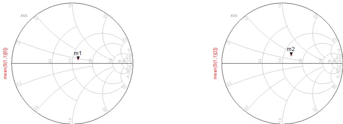
Figura 4.30: Média dos 100 valores resultantes para a impedância de entrada do circuito, para cada uma das frequências de projeto.
