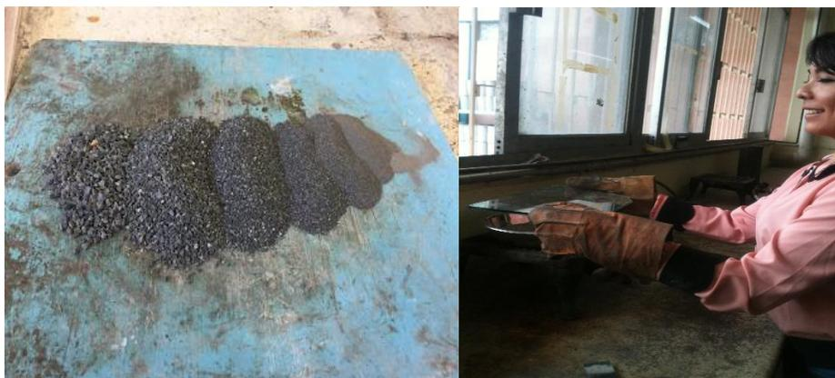
**Fig. 22.** Granulometría del agregado fino y procedimiento para determinar el contenido de humedad.
