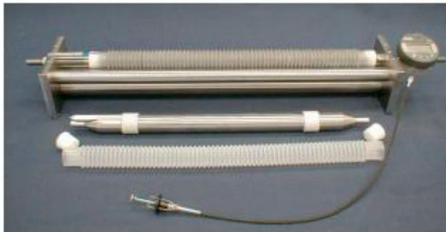
**Fig. 13.** Contracción autógena de acuerdo a la norma ASTM 1698 [53]
