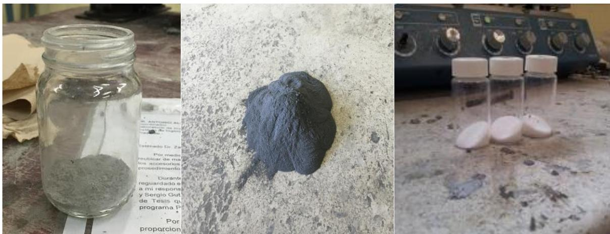
**Fig. 16.** Cemento Portland, Humo de sílice y polímeros súper absorbentes utilizados en la investigación.
