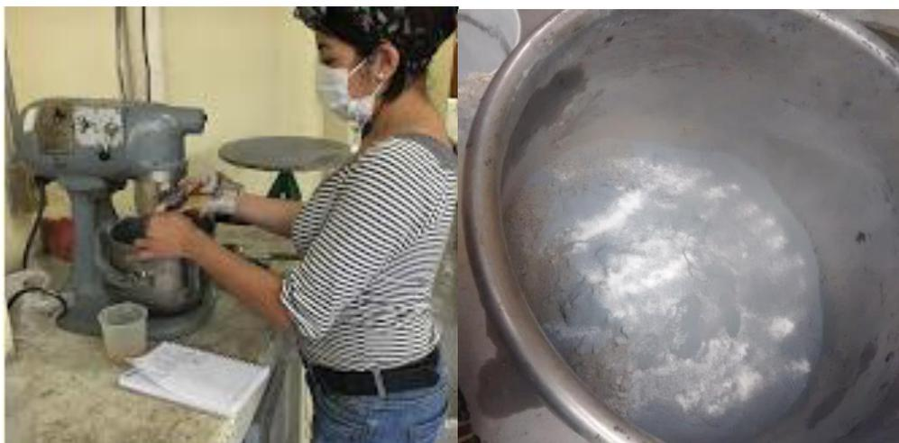
**Fig. 29.** Mezcladora para pastas y mortero (izquierda), del otro lado se observa el cemento, SF y el SAP añadido distribuido uniformemente en la mezcladora (derecho).
