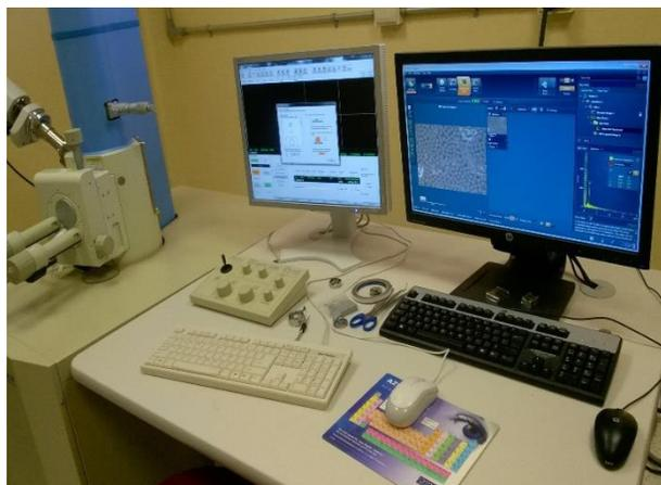
**Fig. 19.** Microscopio Electrónico de Barrido con Espectro de Energía Dispersiva para determinar morfología y composición química elemental.
