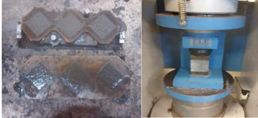
**Fig. 31.** Cubos de mortero recién mezclados (izquierda) y cubos en la máquina universal Elle para la prueba de resistencia a la compresión (derecha).
