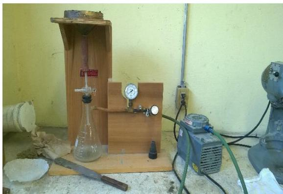
**Fig. 27.** Equipo para extraer una solución de una pasta cementante por medio de un extractor de vacío.
