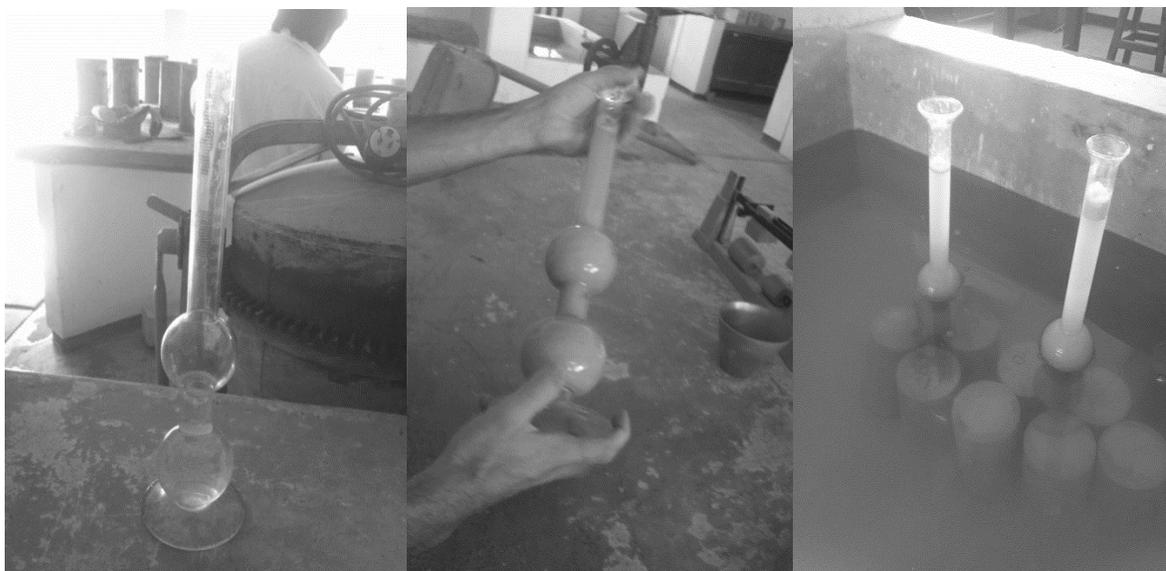
**Fig. 21.** Frasco de Chapman vacío, con el agregado fino y agua; el frasco de chapman con el agregado fino y agua para determinar densidad y absorción.
