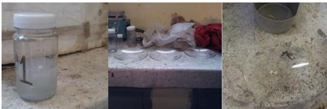
**Fig. 25.** SAP en estado saturado, en estado SSS y en estado seco.
