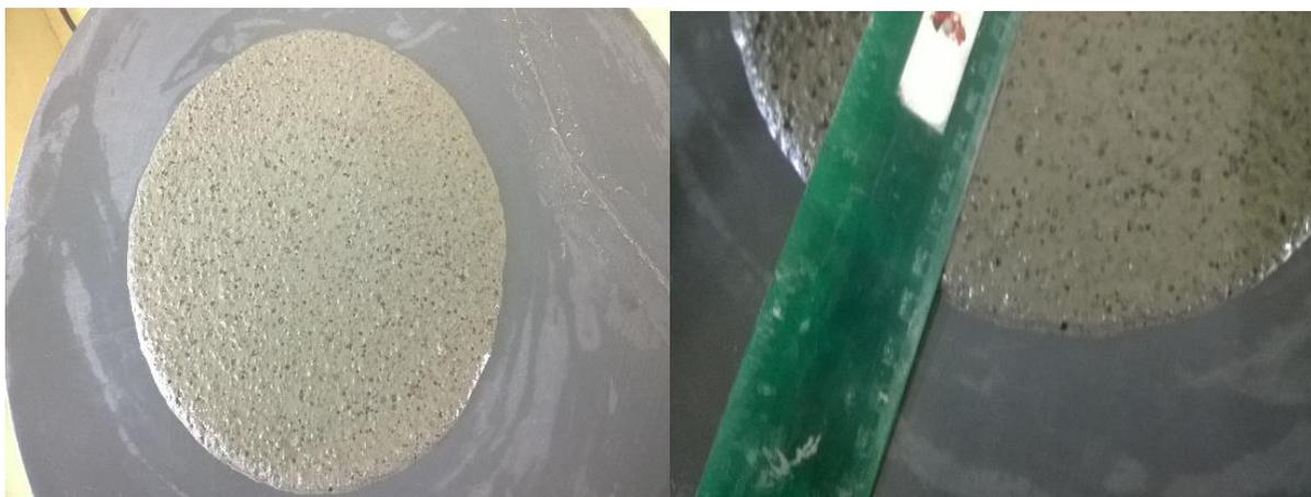
**Fig. 26.** Extensibilidad de mezcla de mortero con SAP.
