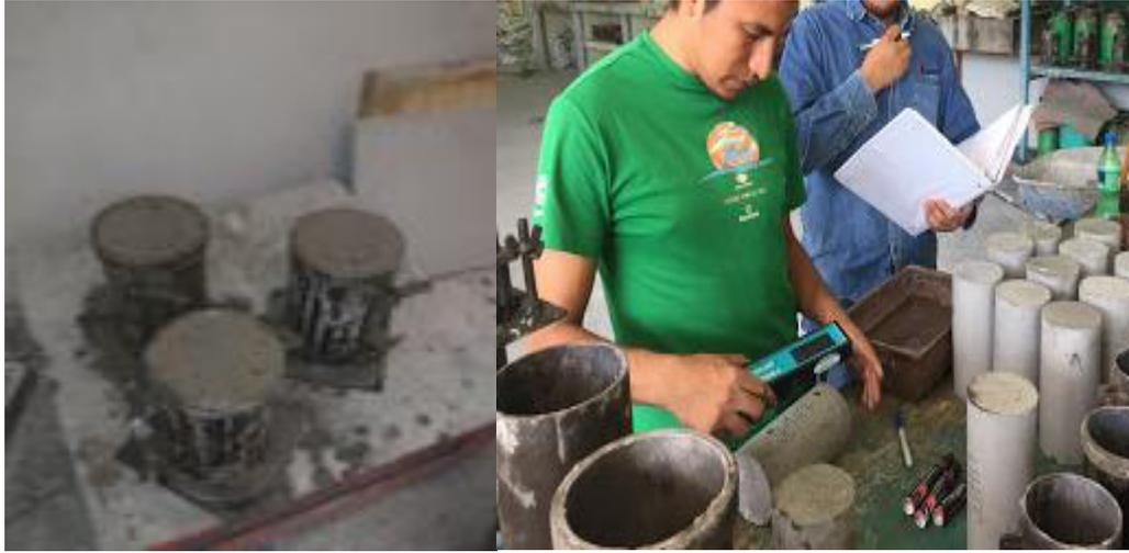
**Fig. 32.** Resistividad eléctrica en cilindros de mortero
