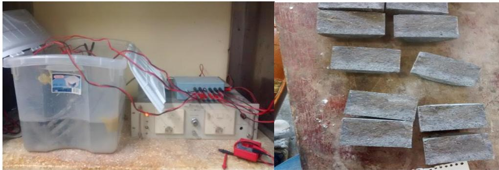
**Fig. 33.** Coeficiente de Difusión de Cloruros en cilindros de mortero
