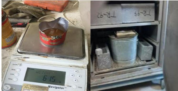
**Fig. 28.** Procedimiento para el cálculo de contenido de sólidos de los aditivos químicos
