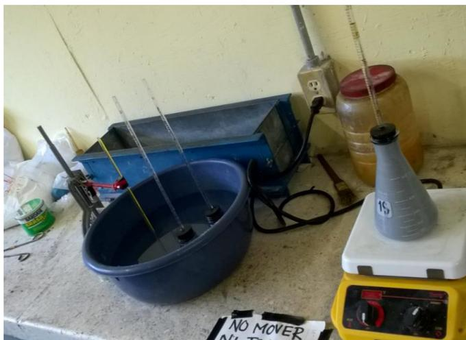
**Fig. 20.** Contracción química por el método de ASTM 1608 y la modificación propuesta por el profesor Zhang.
