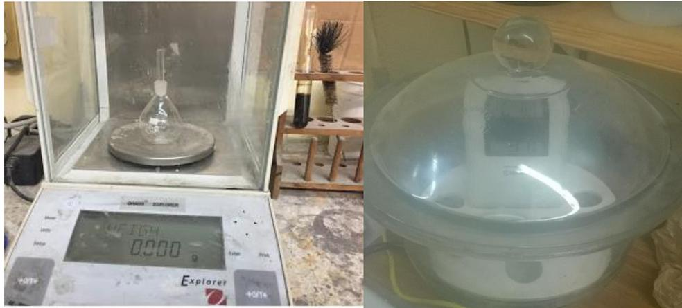
**Fig. 23.** Picnómetro para el cálculo de densidad (izquierda) y disecador para obtener la desorción del SAP con HR del 94% (derecha).
