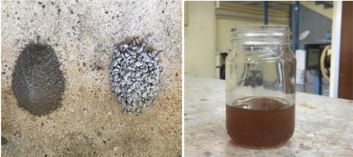
**Fig. 17.** Agregado calizo triturado y aditivo superplastificante usados en la investigación
