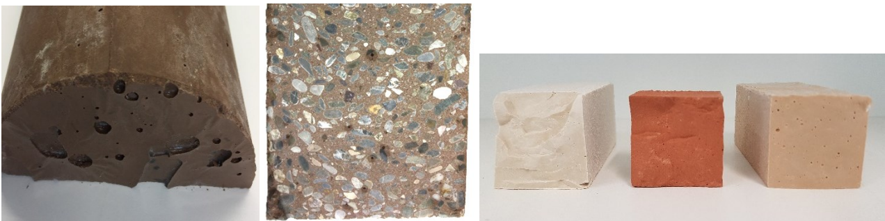
Abb. 1: Links und Mitte: Geopolymerbasierte Betonprobe. Rechts unten: Geopolymere Leimproben. Rechts oben: Ökozement-Logo.
