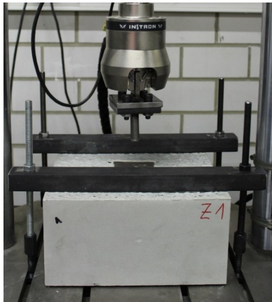
Bild 3: Versuchsaufbau zur Ermittlung der erforderlichen Fügekraft des Klick-Anschluss-Systems
