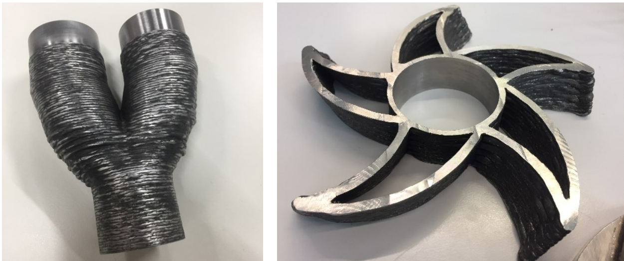
Bild 1: Rohrzusammenführung (links), Pumpenrad mit Außendurchmesser 200 mm (rechts), beides hergestellt an der TU Ilmenau, FG Fertigungstechnik
