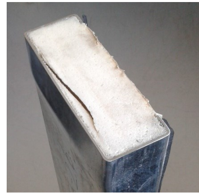
Bild 7: - Getestete Probe mit Bruch im Schaum
