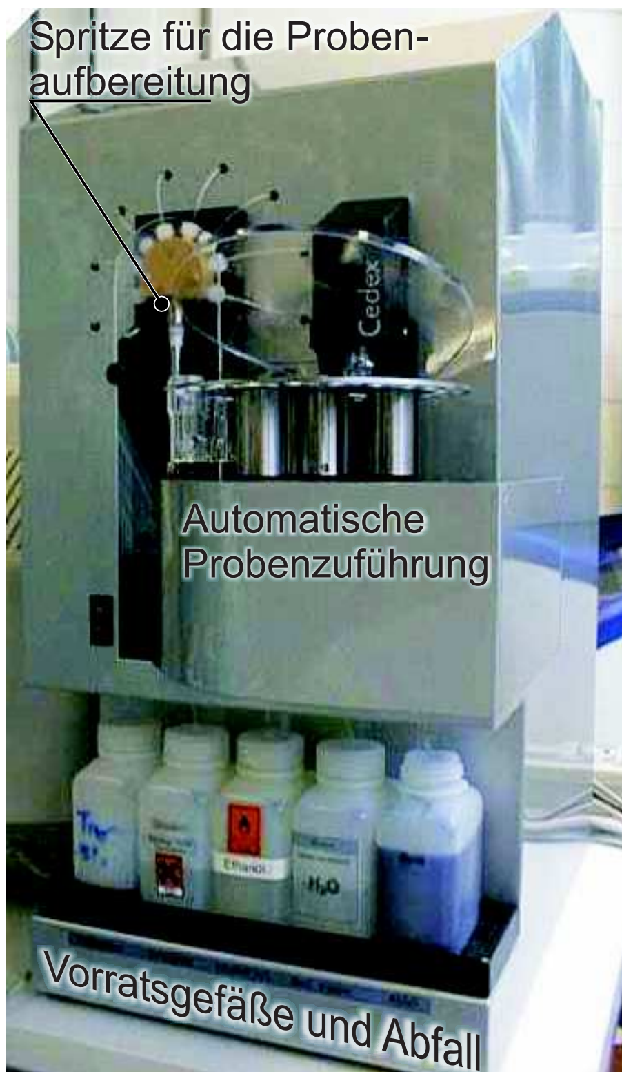
Abbildung 2.13: Das automatische Zellzählgerät CEDEX. Im Bild erkennbar sind die Spritze für die Probenaufbereitung, die automatische Probenzuführung (AS20), und die Reagenzengefäße.
