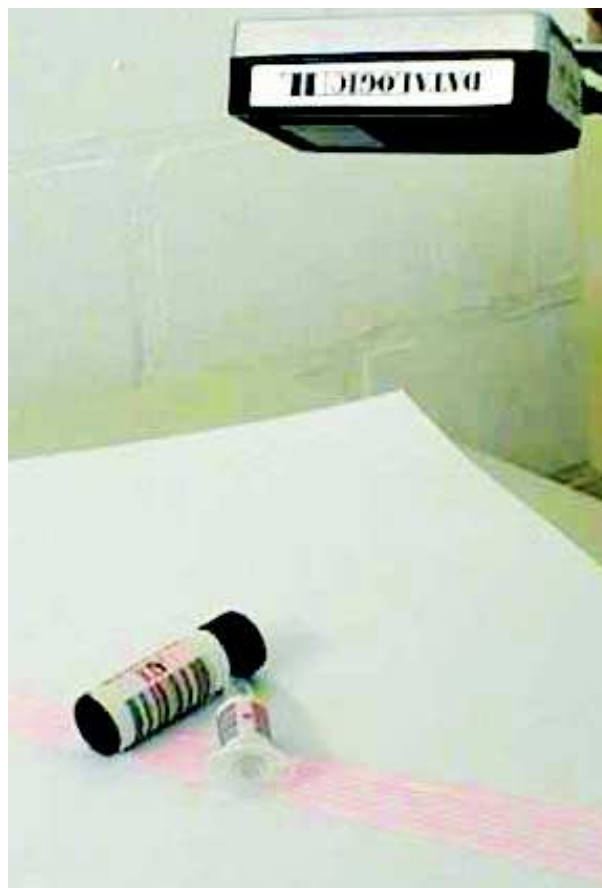
Abbildung 2.15: Barcodescanner mit zwei markierten Gefäßen. Der rote gerasterte Laserstrahl ist im Bild erkennbar.
