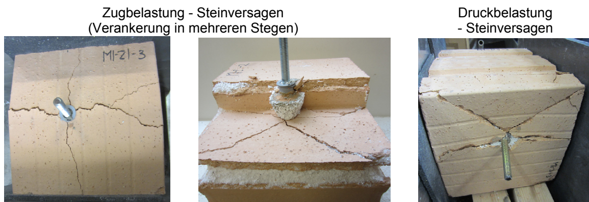
Bild 7.4: Typische Versagensbilder bei Zug- und Druckversuchen in T8-P 6-0,6-10DF (300)
