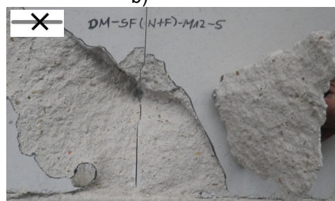
e) SF(N+F)_M12-mechanisch verzahnte Stoßfuge_Dübel M12
