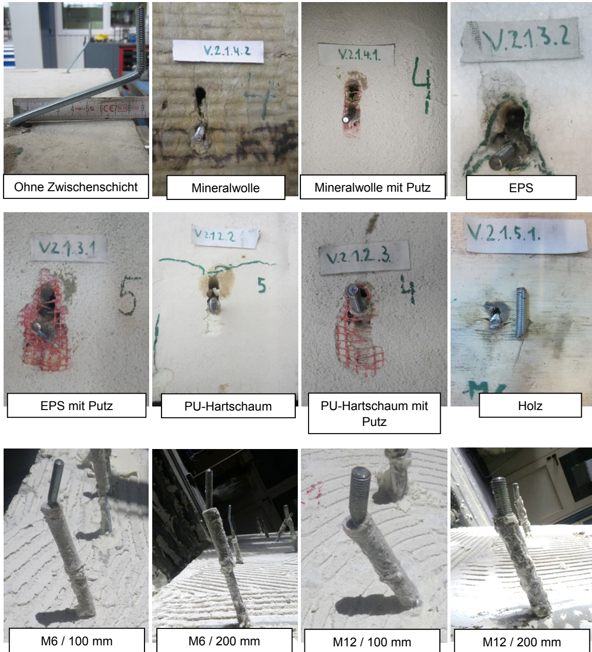
Bild 11.5: Typische Versagensarten (M6) der Querkzugversuche ohne und mit Zwischenschicht (aus Flach (2014)). Anker nach Entfernung der Zwischenschicht
