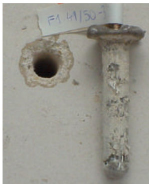
a) Herausziehen des Dübels
