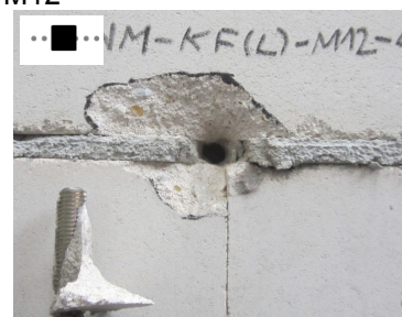
l) NM_KF(L)_M12-Kreuzfuge bei vermörtelter Lagerfuge mit Normalmörtel + nicht vermörtelter Stoßfuge_Dübel M12
