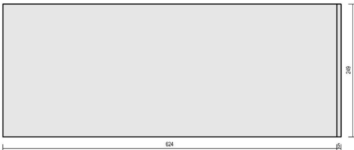
Bild A. 22: Porenbetonstein Ytong PP 4-0,55-624x150x249 NF (DIN EN 771-4, DIN V 4165-100, Z-17.1-540), Maße in [mm]
