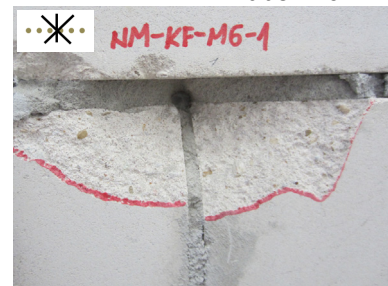
i) NM_KF_M6- Kreuzfuge mit Normalmörtel_Dübel M6
