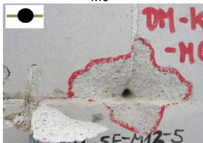
k) DM_KF_M6- Kreuzfuge mit Dünnbettmörtel_Dübel M6
