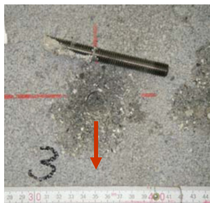
e) Herausziehen des Dübels
