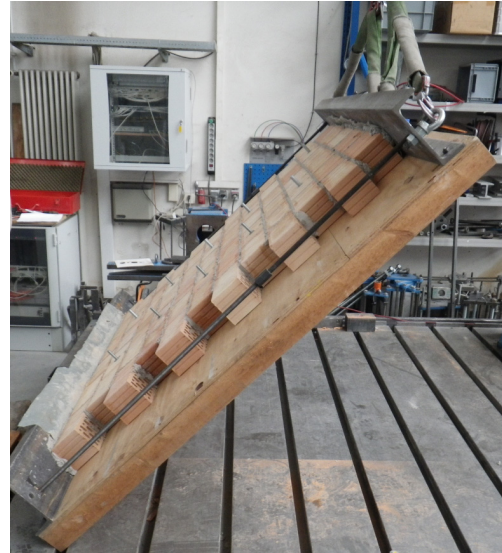
b) Mauerwerksscheibe beim Ablegen
