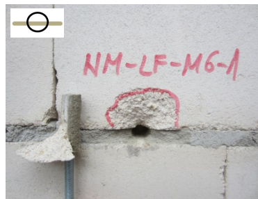
g) NM_LF-Lagerfuge mit Normalmörtel_Dübel M6
