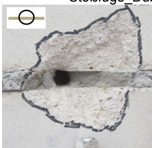
g) NM_LF_M12-Lagerfuge mit Normalmörtel_Dübel M12
