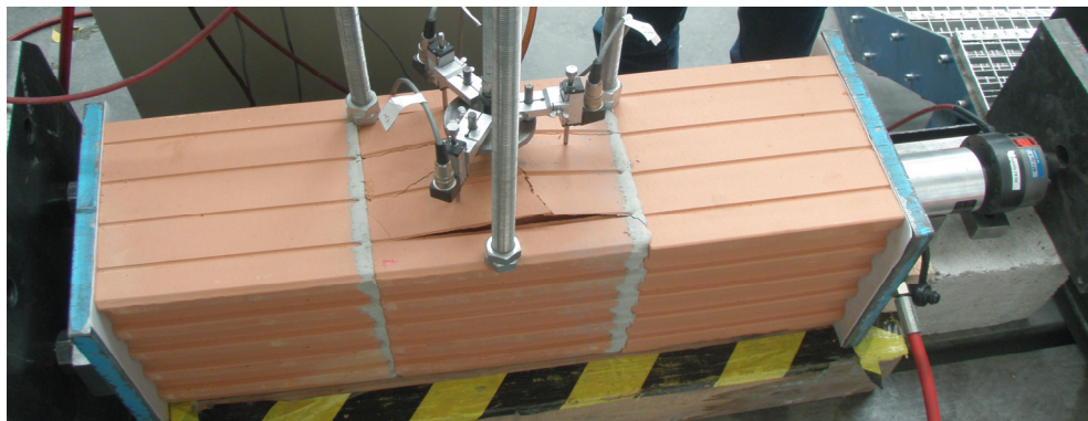
Bild 4.4: Versuchseinrichtung des Zugversuchs im virtuellen Verband (mehrere Abspannungskräfte) - bei Hochlochziegel HLz 6-0,7-10DF (300) (DIN EN 771-1, Z-17.1-679/760)
