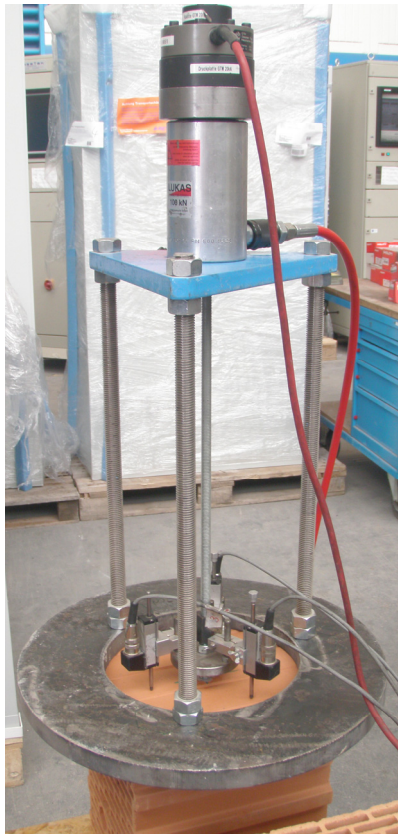
Bild 4.6: Versuchseinrichtung des Zugversuchs mit weiter Abstützung (Ring) im Einzelstein
