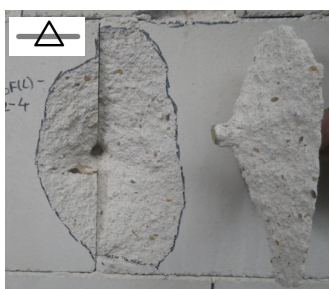
d) SF(L)_M12-nicht vermörtelte Stoßfuge_Dübel M12
