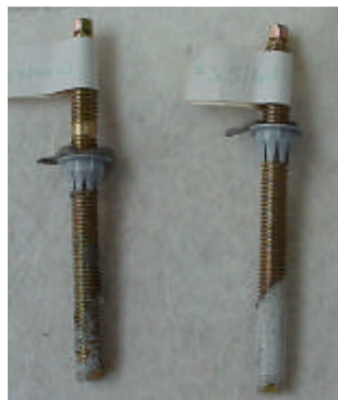
b) Herausziehen der Ankerstange
