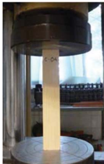
Fig. 2. Probeta de madera de Pino silvestre utilizada para la caracterización mecánica de la resistencia a compresión simple
