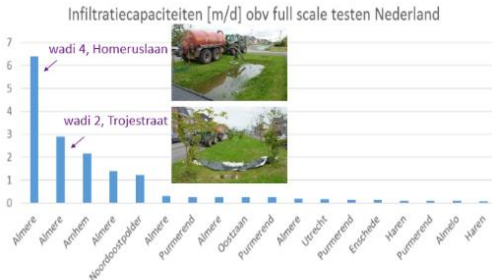
Afbeelding 3. Onderzoeksresultaten full scale test bij wadi's in Almere vergeleken met onderzoek in andere gemeenten.
