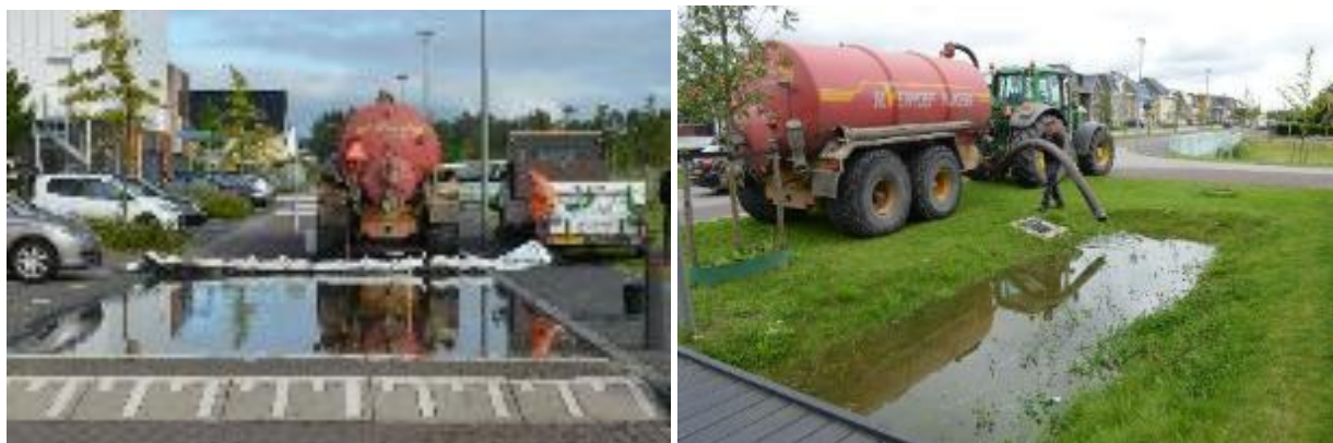
Afbeelding 1. Full scale test aan doorlatende verharding in de David Livingstonestraat en een wadi aan de Homeruslaan.
