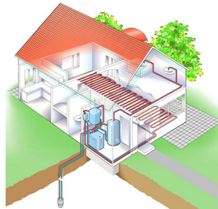
Afb. Schematische weergave systeem aardwarmte
