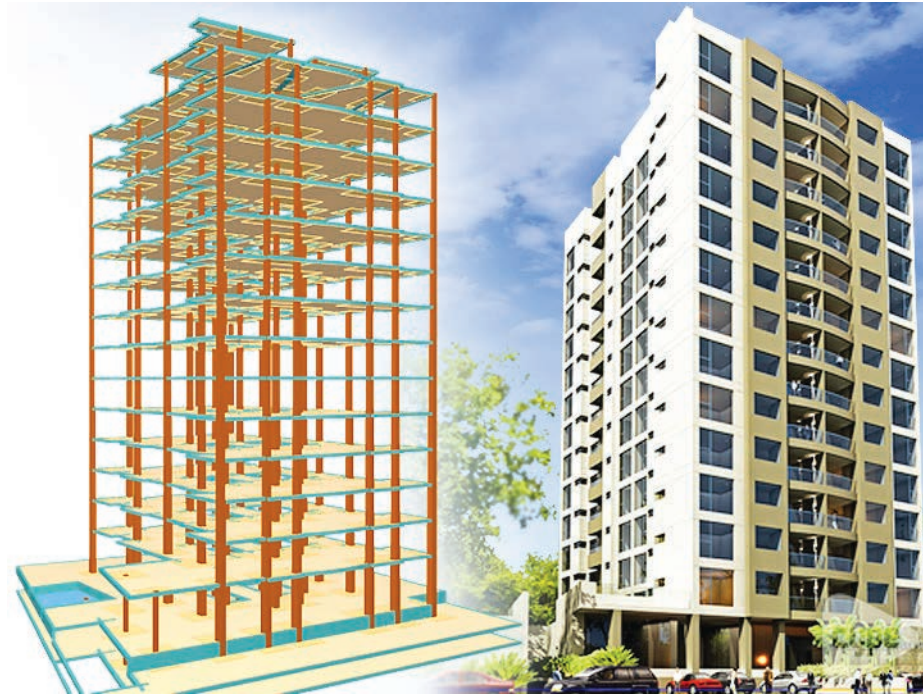
Figura 6.4 Proyecto de Altos del Sur - Modelo de CYPECAD facilitado por: CLERHP Estructuras S.R.L. Edificio de 12000 m 2 en 2 sótanos y 15 pisos, el proyecto de Altos del Sur se encuentra en Santa Cruz de la Sierra, Bolivia.
