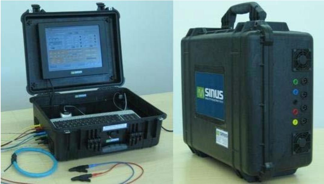
Figura 3.21 – Sistema de monitorização desenvolvido pelo GEPE: Resultado final da montagem do hardware [38].
