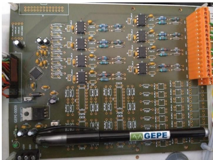
Figura 4.11 - Resultado final da placa de condicionamento de sinal e de ADC.
