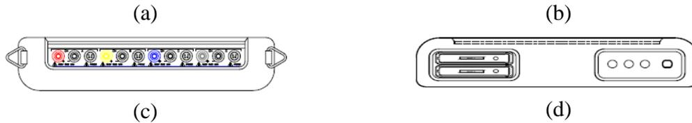
Figura 3.2 - Dranetz PowerXplorer PX5: (a) face frontal; (b) face traseira; (c) face superior; (d) face inferior [32].
