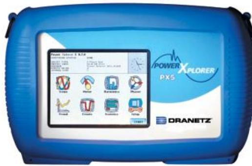
Figura 3.1 - Sistema de monitorização de QEE: *Dranetz PowerXplorer PX5* [32].
