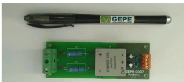
Figura 4.2 - Sensor de tensão utilizado.
