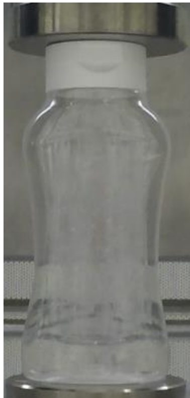
Figura 15: Embalagem entre os pratos da máquina no instante de tempo de ensaio inicial.
