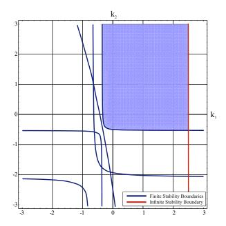
Figure 4.9 : Case study III: Stabilizing parameter space.
