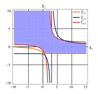
Figure 4.5 : Case study I: Stabilizing parameter space.
