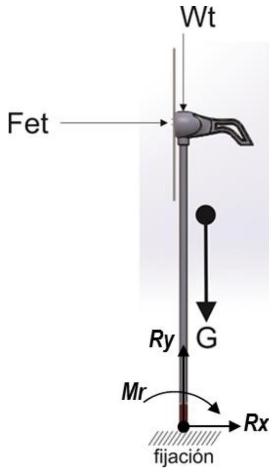
Figura 28. Condiciones Cálculo Poste Turbina
