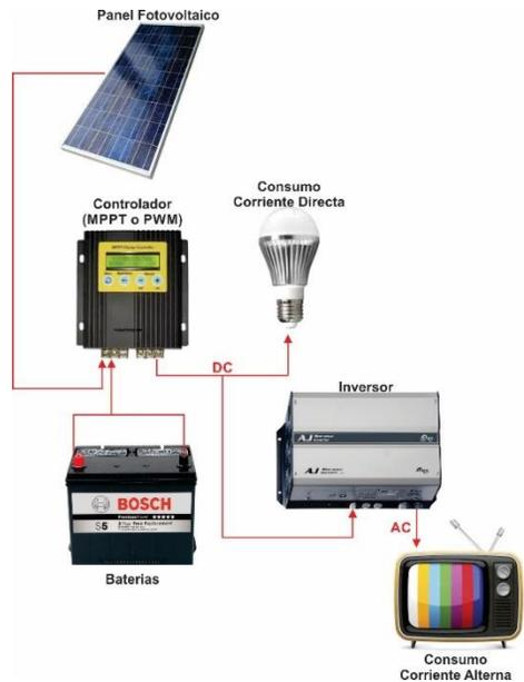
**Figura 1. Diagrama de Instalación Sistema Fotovoltaico.**
