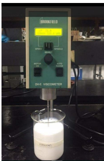
Figura 8. Viscosímetro de Brookfield para medición de la viscosidad de látex
