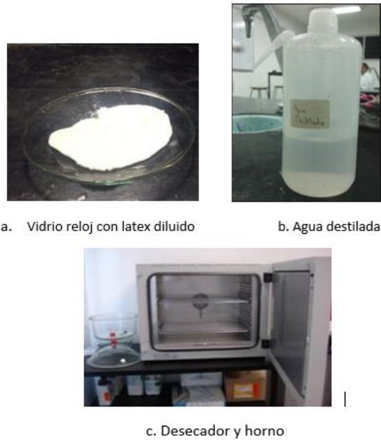
Figura 10. Materiales y equipos necesarios para la determinación de porcentaje de sólidos totales.
