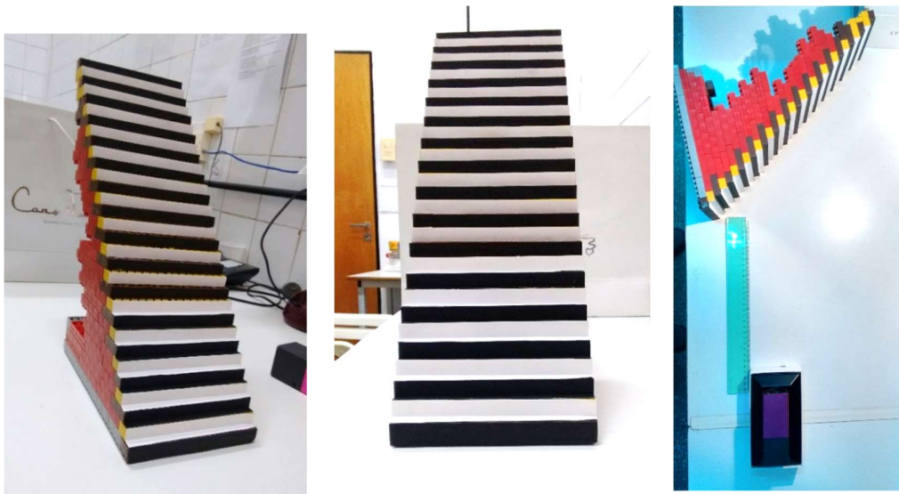
Figura 5.2. Montaje de la escena con fantoma escalera. Son 31 peldaños de 1cm de frente y 1 cm de altura.
