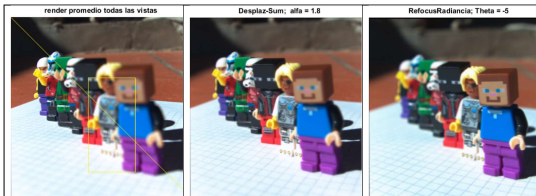
Figura 5.13. Preservación de los atributos de brillo, contraste y balance de color. La imagen original con su foco óptico (izq.) y dos ejemplos de reenfoque (centro: Desplazamiento-Suma y der.: Sesgado de la Radiancia ).
