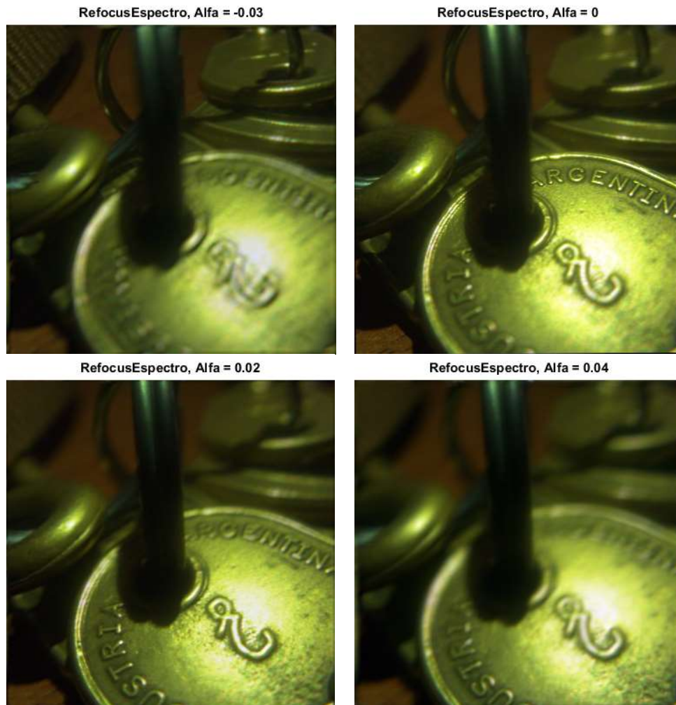
Figura 3.24. Refocalizaciones por corte del hiperespacio de Fourier de la radiancia. Alfa<0 hace foco en el fondo de la escena (alejado de la cámara). Alfa>0 hace foco en el frente de la escena (cercano a la cámara).
