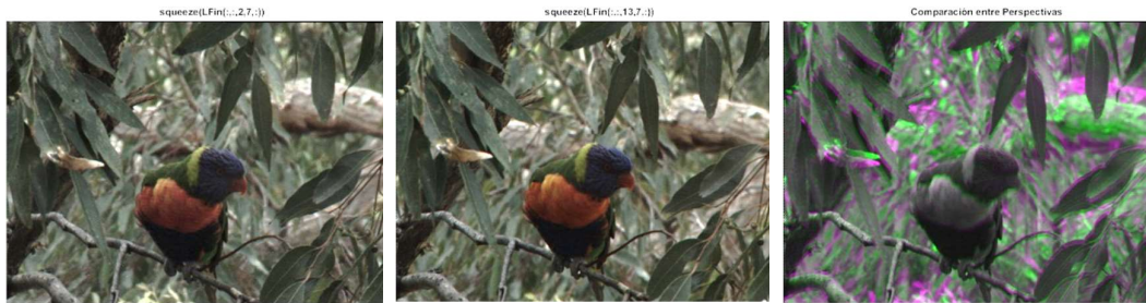
Figura 5.3. Visualización de 2 perspectivas diferentes, cámara Lytro Illum, LF(433,625,15,15,3). Izq.: selección del pixel (renglón,columna)=(2,7) para cada microlente. Centro: selección del pixel (renglón,columna)=(13,7) para cada microlente. Der.: diferencia de las posiciones de los elementos de la imagen por cambio de perspectiva en comparación por superposición de las dos imágenes anteriores. Imagen de acceso libre en [62].
