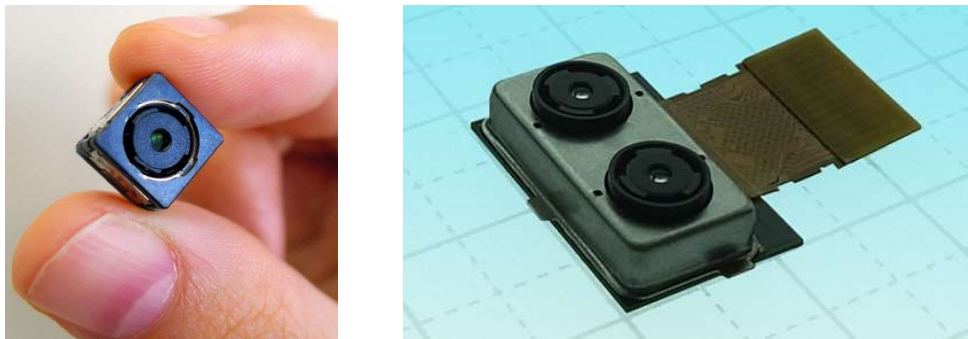
Figura 2.26. Izq.: Microcámara plenóptica de 8Mp desarrollada por Toshiba. Der.: Módulo TCM9518MD de Toshiba. Fuente: [48].
