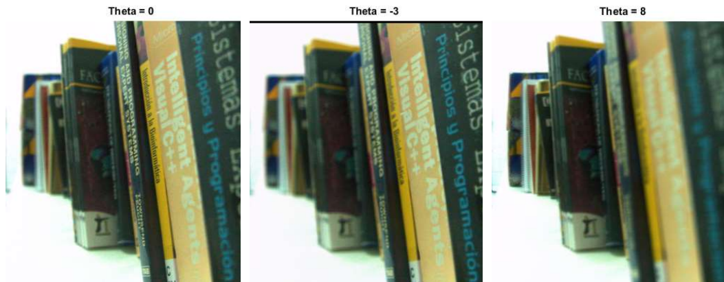
Figura 3.11. Refocalización por transformación de la radiancia. Theta=0 significa que no hay transformación y la imagen es la del enfoque óptico de la cámara. Theta=-3 enfoca a una distancia más cercana a la cámara, mientras que Theta=8 refocaliza a una profundidad mayor.
