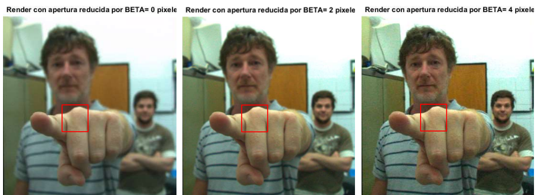
Figura 3.3. Influencia de la apertura de las microlentes. En la figura de la izquierda no hay modificación, por lo tanto la imagen presenta el foco como fue capturado originalmente por la cámara plenóptica. A medida que disminuye la apertura, se incrementa la profundidad de campo.
