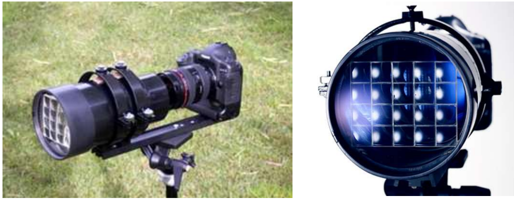
Figura 2.21. Izq.: Segunda Generación de Adobe LF Camera. Der.: Lente con matriz rectangular de sub-lentes. Fuente: [42].
