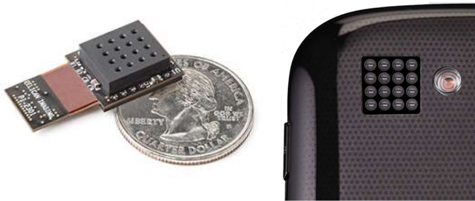
Figura 2.24. Matriz de microcámaras “PiCam”, integrada en un teléfono móvil. Fuente: [45].
