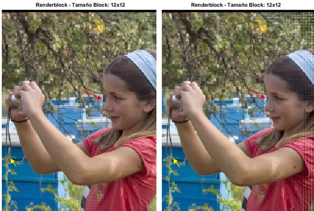
Figura 3.8. Renderización de una imagen capturada con una cámara Plenoptic 2.0 [40]. Los bloques son de 12x12 píxeles (para microlentes de 75x75 píxeles) y se eligieron posiciones (1,1) para la izquierda y (1,30) para la derecha. La niña está en foco mientras que el fondo se ve desenfocado y presenta artefactos, que se explicarán más adelante. Se muestran flechas para indicar donde es más evidente la diferencia por perspectiva.
