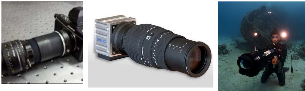
Figura 2.23. Diferentes prototipos de cámaras plenópticas desarrolladas por el Grupo CAFADIS de la Universidad de La Laguna. Fuente: [44].
