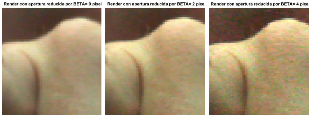
Figura 3.4. Ampliación de los sectores de la imagen de la Figura 3.3, encerrados en recuadros. Se observa cómo se incrementa el ruido a medida que disminuye la apertura de las microlentes.
