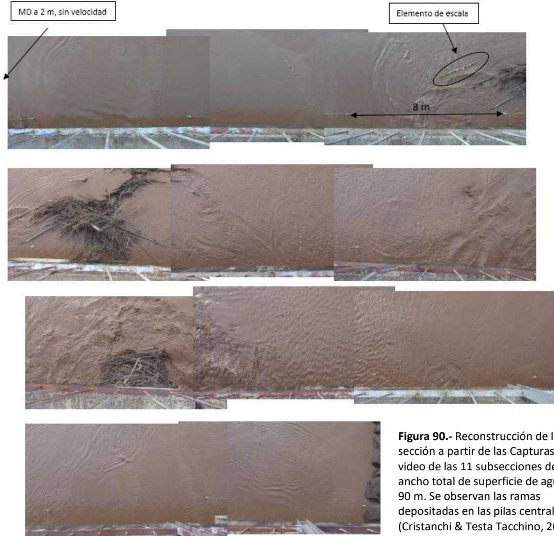
**Figura 90.-** Reconstrucción de la sección a partir de las Capturas de video de las 11 subsecciones del río, ancho total de superficie de agua 90 m. Se observan las ramas depositadas en las pilas centrales (Cristanchi & Testa Tacchino, 2014).
