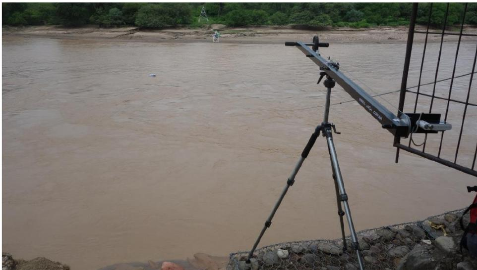
**Figura 92.-** Configuración del sistema para la implementación de la técnica de PIV. La cámara digital se ha montado sobre una grúa desde la margen izquierda del río (Szupiany, y otros, 2014).
