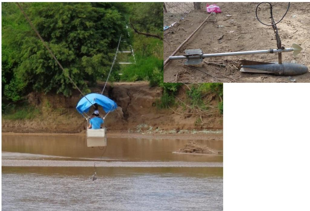
**Figura 89.-** Aforo con Molinete sobre vagoneta. Sección MLP, enero 2014 (Cristanchi & Testa Tacchino, 2014).
