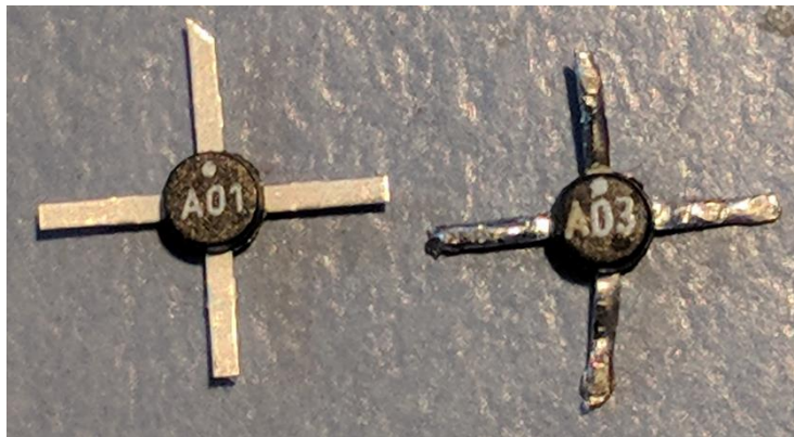
Figura 18 – Amplificadores MAR-1 (izquierda) y MAR-3 (Derecha)
