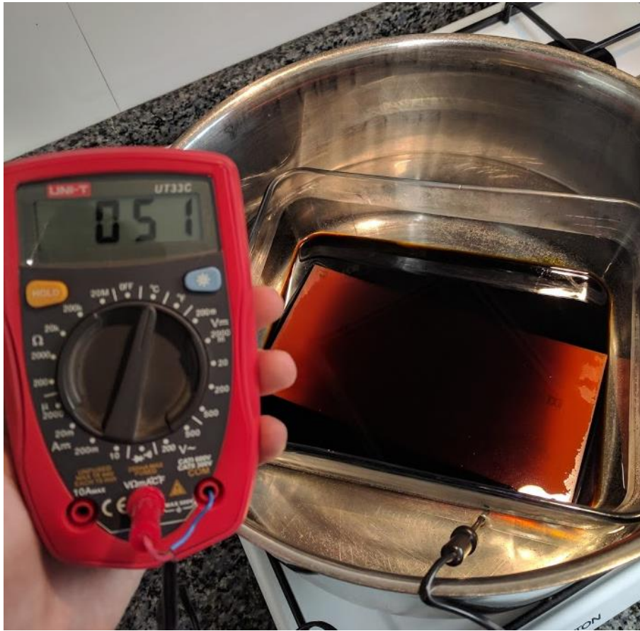
Figura 46 – Placa de cobre sumergida en percloruro férrico a baño maría.
