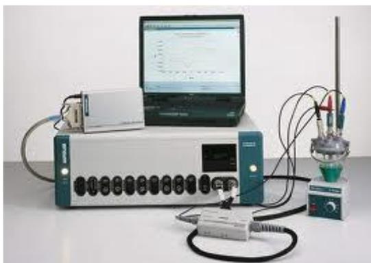
***Figura 2.2 Potenciostato-galvanostato ECO CHEMISTRY AUTOLAB***
