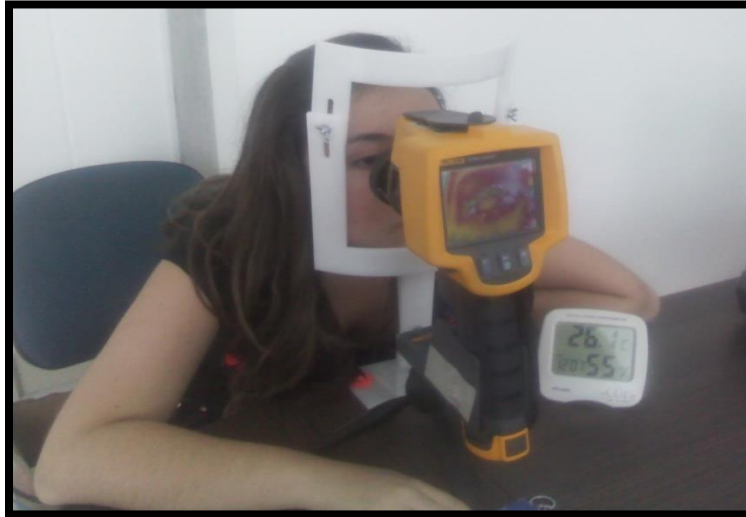
Figura 13. Montaje experimental con la cámara termográfica Ti32.
