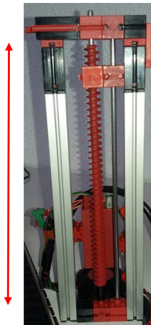
Ilustración 8. Eje z del manipulador
